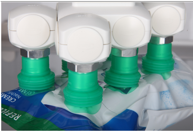
Ventosas de fuelle SPB4 durante la manipulación de bolsas y envases de forma inestable
